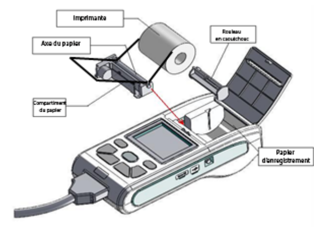
Figure 6 -1 Installation du papier d'enregistrement
