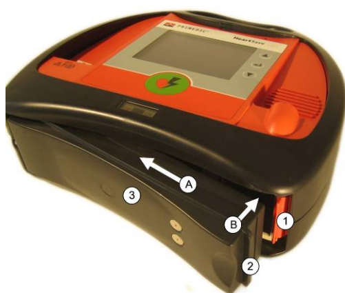
Fig. 10 : Mise en place du module d'énergie
