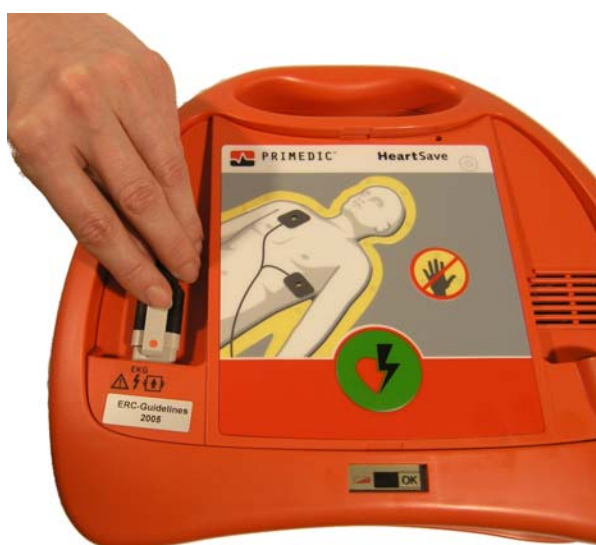
Fig. 12: Insérer la fiche des électrodes
