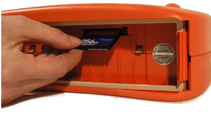
Fig. 7: Insérer / remplacer la carte mémoire
