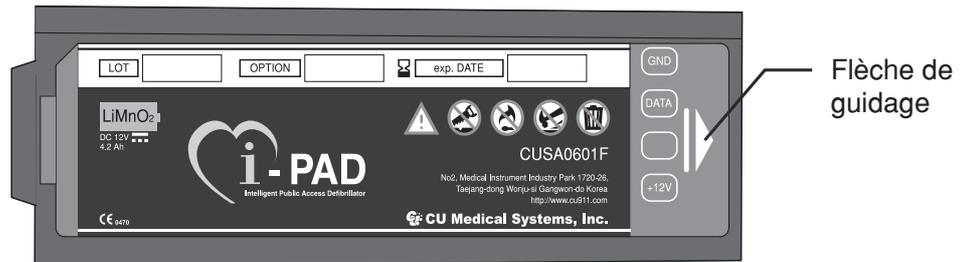
3. Appuyez jusqu'à ce que vous entendiez un cliquètement du mécanisme de verrouillage.
