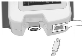
Figure 5.16 Schéma pour le branchement entre le lecteur d'écran d'apnée du sommeil et la ligne de données USB
