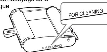
Pour maintenir la qualité d'impression, nous vous recommandons d'effectuer un nettoyage régulièrement, ainsi qu'à chaque remplacement du pack d'impression (lorsque le pack d'impression utilisé est épuisé). Pour nettoyer la tête thermique, le dos de la feuille de protection fournie avec les packs d'impression UPC-21S et UPC-21L peut être utilisé comme feuille de nettoyage.
