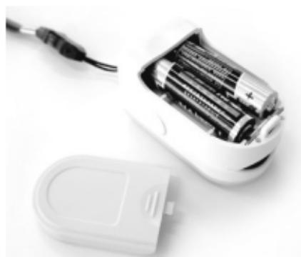
Figure 3. Installation des piles
