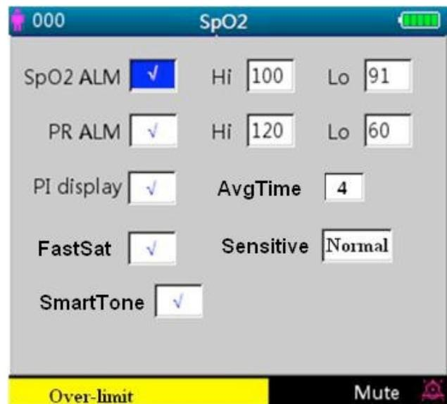
Figure 4.12B Écran paramètres SpO2 (avec module Masimo SpO2)
