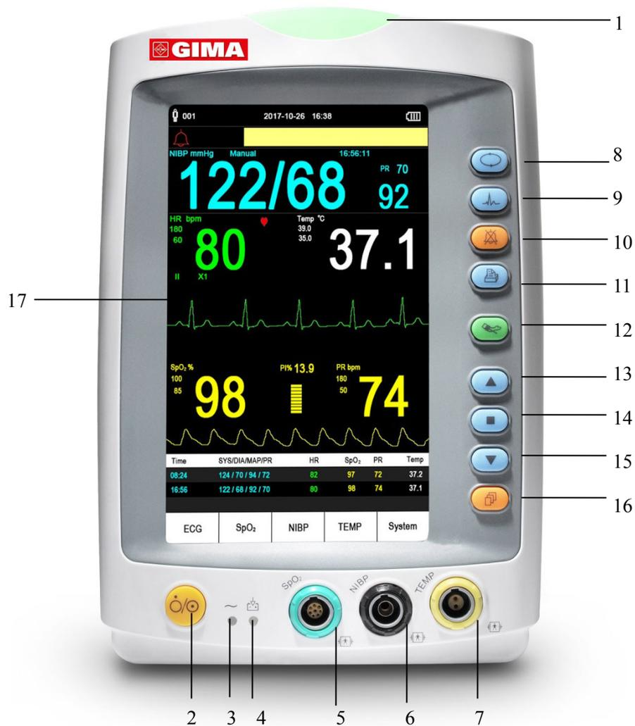
**Figure 3.1B Illustration du panneau avant du moniteur (avec fonction ECG)**
