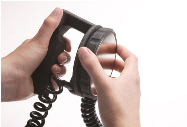
Fig. 15: Enclenchement des palettes pour adultes sur les électrodes pour enfants
