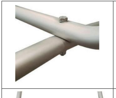
Prendre 1 vis TE, 2 rondelles et 1 écrou et, en utilisant la clé Allen, fixer le bâti et le tube avec les roues comme sur la photo. RÉPÉTER LA MÊME OPÉRATION AVEC L'AUTRE TUBE DOTÉ DE ROUES.
