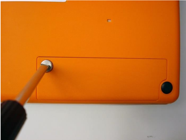
1. Ouvrir le couvercle de la batterie à l'aide d'un tournevis.
