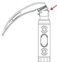
Fig. 2) Engagez la lame dans la poignée en appliquant une force suffisante
