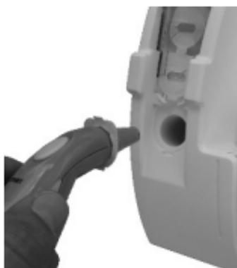
Полностью вдавите чувствительный элемент в отверстие держателя колпачка.
