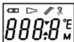
2. В течение 2 секунд автоматически будет высвечено последнее измеренное значение, сопровождаемое иконкой «М».
