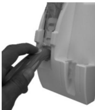
Возьмите прибор, вертикально введите чувствительный элемент в центральную часть колпачка.
