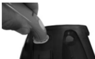
Возьмите прибор, вертикально введите чувствительный элемент в центральную часть колпачка.
