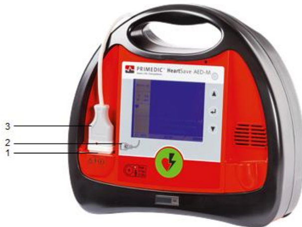
Εικ. 17: Σύνδεση βύσματος ηλεκτροδίων
