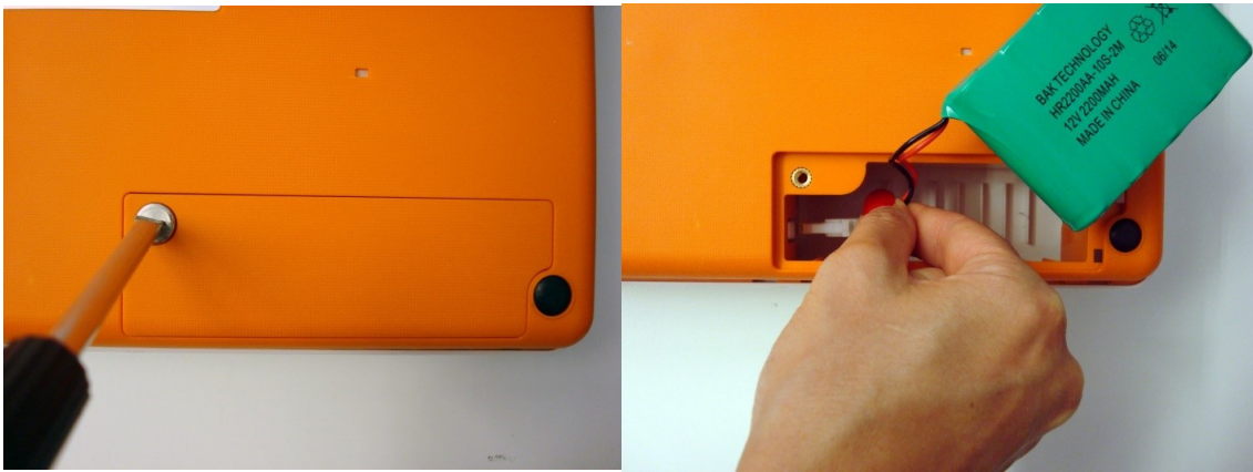
1. Ανοίξτε την πόρτα της μπαταρίας με ένα κατσαβίδι. 2. Αποσυνδέστε τη φίσα της μπαταρίας.
