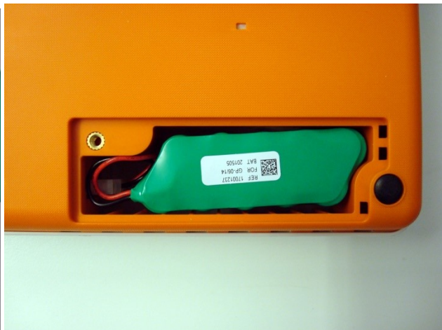
4. Postaviti bateriju u ležište.
