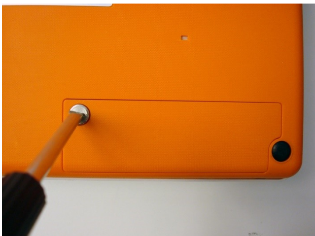
1. Otvoriti vratašca baterije pomoću odvijača.
