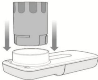
以顺时针方向转动涡轮，直到卡止在正确位置。
