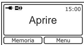
Il simbolo della spina indica l'alimentazione di rete. Una freccia nel simbolo della accumulatori indica che la accumulatori è in carica.
