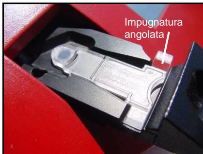
Figura 15 - Cuvetta posizionata correttamente
