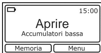
Il simbolo della batteria indica la capacità residua. Quando la carica residua della batteria è bassa il dispositivo visualizza "Batteria bassa". Se la batteria non viene ricaricata, il dispositivo si spegne dopo poco.
