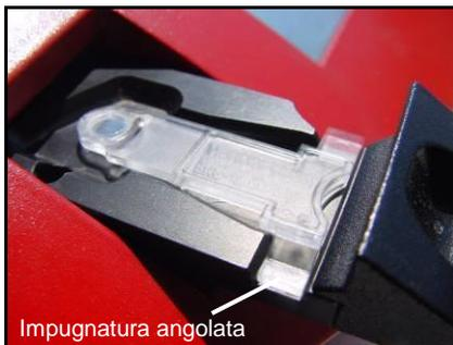
Figura 16 - Cuvetta non posizionata correttamente
