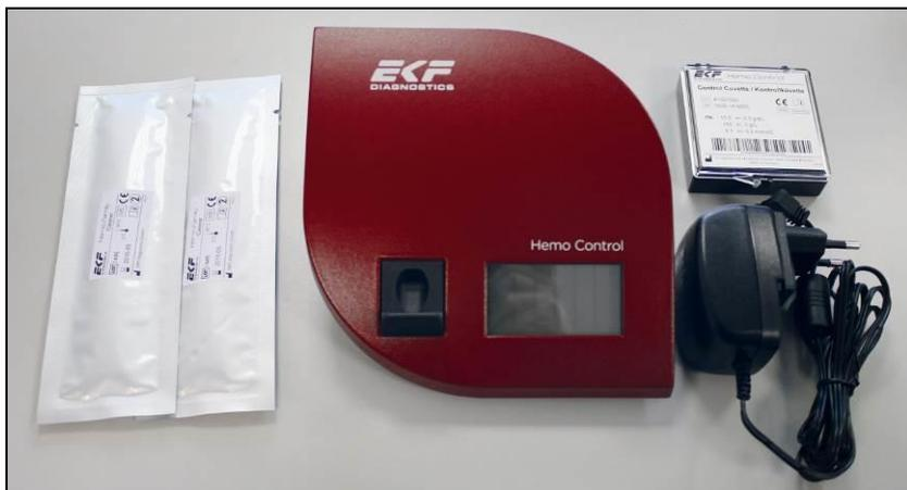
Figura 1 - Hemo Control con alimentatore, cuvetta di controllo e detergente
