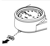
Rimuovere il fermo di trasporto dalla parte inferiore dell'alloggiamento.
