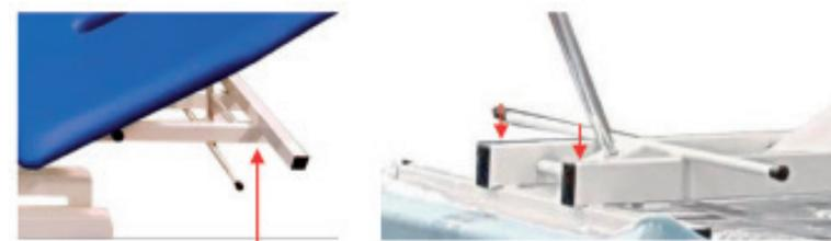
Procedere nello stesso modo del lettino standard ma fissare il portarotolo al telaio sottostante la testiera dove trovate i fori predisposti per il fissaggio. Quindi fissare tramite n.2 viti 5x20 il portarotolo nella posizione evidenziata dalle frecce.
