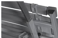
Infilare contemporaneamente i due lati e fargli entrare in parallelo per evitare che si blocchino.
