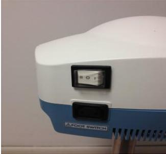
In prossimità della presa pedale, si trova un commutatore che ha lo scopo di far funzionare lo stesso dispositivo direttamente a rete elettrica oppure tramite funzionamento a pedale.
