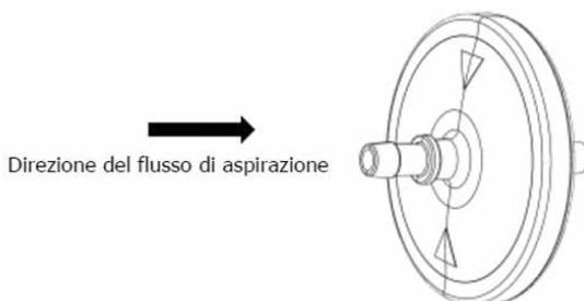
Assicurarsi che il filtro sia montato con le frecce a lato del paziente
