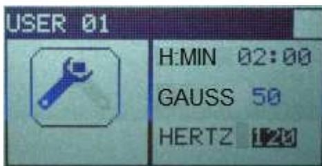
7. Tramite i tasti ▲ e ▼ impostare la frequenza del trattamento (da 0 a 120) e confermare premendo il tasto OK. Il dispositivo si riporterà nella schermata del punto 6, evidenziando l'icona della chiave sul lato sinistro del display: premere il tasto ▼ per evidenziare l'icona del magnete;
