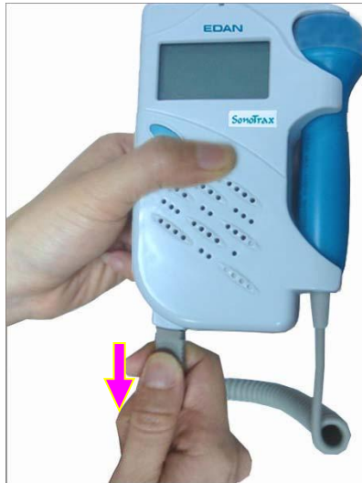
Figura 3-6 Rimozione della sonda
