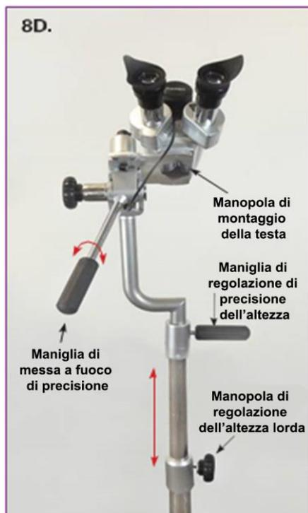
8D. Agire sulla maniglia di regolazione spostando leggermente la testa del colposcopio verso l'alto o verso il basso. Utilizzare la manopola di regolazione dell'altezza totale per effettuare regolazioni più ampie dell'altezza.
