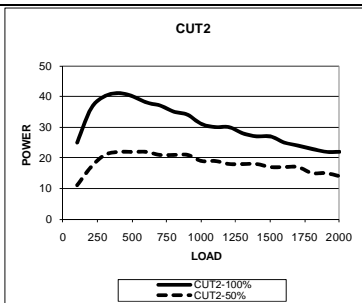
Diagramma della massima e media potenza su carico variabile 100-2000Ω CUT2
