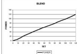
Diagramma della Potenza di uscita BLEND sul carico nominale
