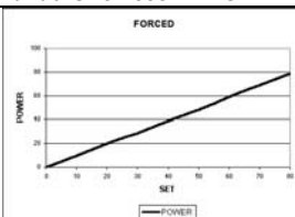
Diagramma della Potenza di uscita FORCED sul carico nominale
