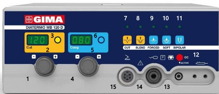
1. Manopola per la regolazione del livello di potenza in uscita della funzione CUT
