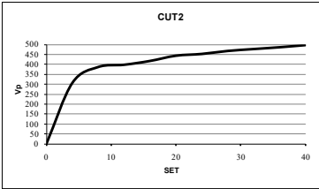
Diagramma della massima tensione di uscita (Vp) per CUT2
