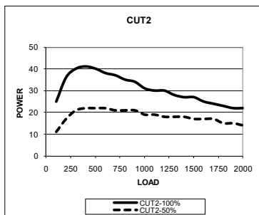
Diagramma della massima e media potenza su carico variabile 100-2000 \Omega CUT2
