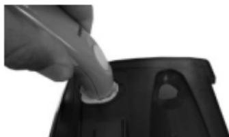
Tenendo l'apparecchio, inserire verticalmente la sonda nel centro del copri sonda
