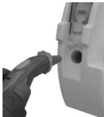
Premere completamente la sonda all'interno del foro del copri-sonda.
