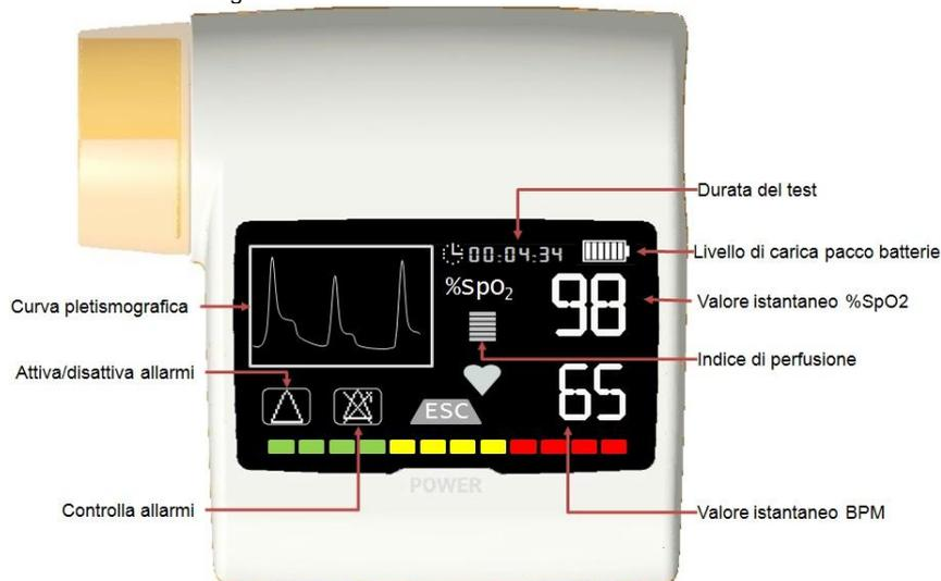
Per terminare un test di ossimetria premere il tasto di accensione/spengimento. Se viene toccata l'icona ESC viene mostrato per pochi secondi il seguente messaggio:
