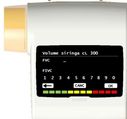
Prima di inserire i nuovi valori di calibrazione, controllare che il valore del volume della siringa in uso sia corrispondente a quanto riportato in alto destra; per modificare il valore del volume della siringa toccare l'icona
