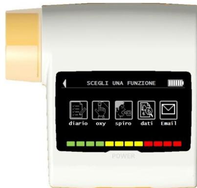
Per inserire la turbina in modo corretto spingerla in fondo e ruotarla in senso orario fino alla battuta che assicura l'avvenuto blocco all'interno del contenitore plastico.
