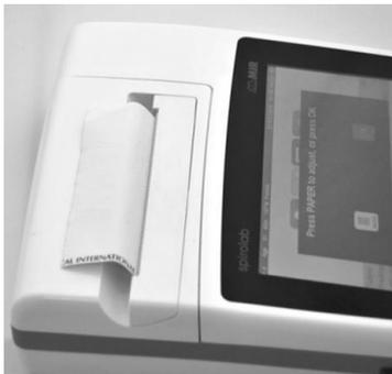
3) spingere la carta all'interno del rullo di avanzamento (rullo nero della stampante termica); un sensore rileverà la presenza della carta e la farà avanzare automaticamente. Se necessario far avanzare la carta premendo
