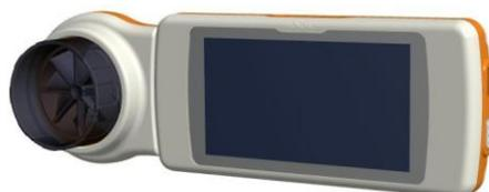
Lo strumento è destinato alla misura dei parametri respiratori ed al monitoraggio della saturazione di ossigeno e della pulsazione cardiaca. Lo strumento effettua un test di controllo sulla qualità dei valori restituiti ed ha internamente una capacità di memoria sufficiente per circa 10000 test spirometrici o al massimo 300 ore di ossimetria.
