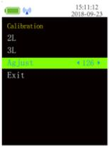
Figura 19 Interfaccia di regolazione della calibrazione
