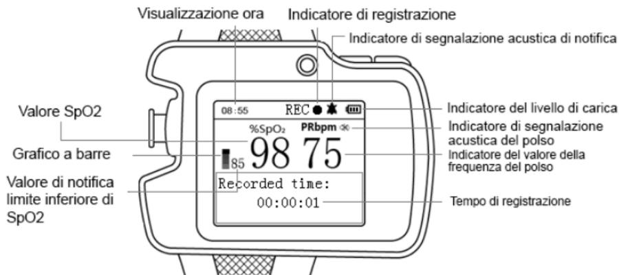
Figura 4.2 Interfaccia di registrazione
