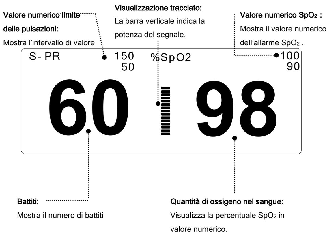
Il display visualizza il valore corrente dell'SpO<sub>2</sub> e la frequenza cardiaca (RATE) che se ne deriva. Le tacche della barra indicano la qualità del segnale (massimo venti tacche). Ogni 6 secondi l'apparecchio calcola la media dei valori di SpO<sub>2</sub> rilevati.
