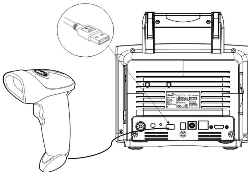
Il codice a barre che si desidera immettere è abbinato al LED indice generato dallo scanner e se si preme il pulsante di input, l'ID corrispondente viene letto e inviato all'apparecchiatura. L'ID mittente viene visualizzato nella parte superiore centrale dello schermo.
