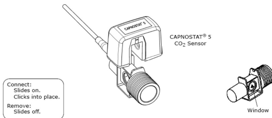
La figura di seguito mostra un Sensore CAPNOSTAT 5 CO2 con un circuito paziente:
