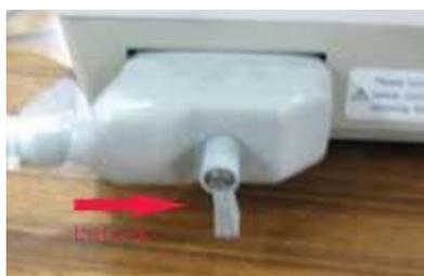
Fig. 3-5-3 Sonda in posizione "OPEN"
