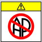
(b)                                                                                                     | (a) Indicazioni generiche di avviso, attenzione, rischio di pericolo.<br>(b) PERICOLO: se il sistema viene utilizzato con anestetici infiammabili, sussiste il rischio di esplosione. |
