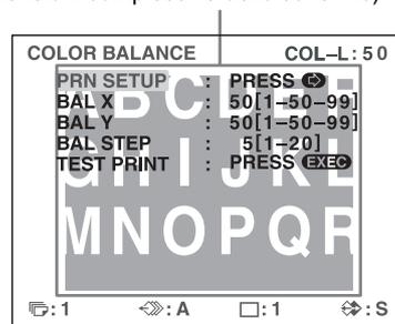
Quando si regola il bilanciamento dei colori per la prima volta dopo l'acquisto della stampante, BAL X, BAL Y e BAL STEP sono impostati sui loro valori predefiniti di 50, 50 e 5.
