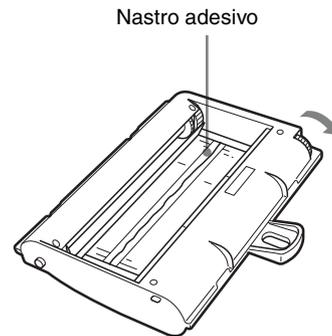
Avvolgere il nastro inchiostro fino a quando il nastro adesivo non è più visibile ruotando nella direzione della freccia la rotella nera (o grigia) sul lato di avvolgimento (assicurarsi che il nastro inchiostro risulti teso e senza lasco).
