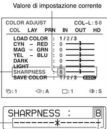
Il valore di impostazione aumenta ad ogni pressione del pulsante → e diminuisce ad ogni pressione del pulsante ←.
