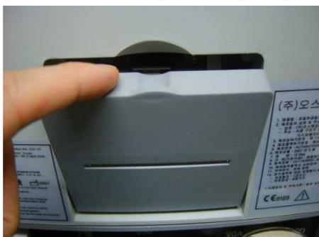
2) Caricamento della carta: caricare la carta come indicato in figura. La superficie esterna del rotolo deve essere rivolta verso l'interno del dispositivo. La carta scorre automaticamente.
