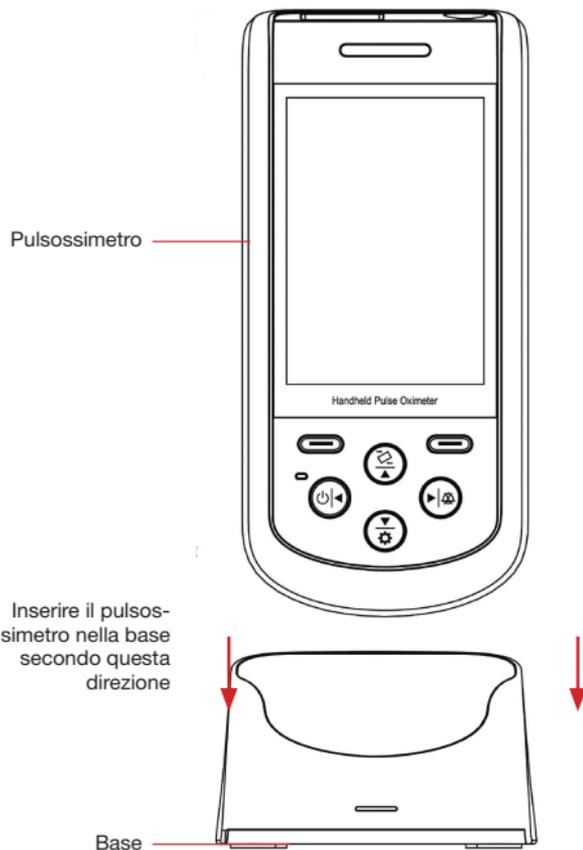
Figura 2.2 Collegamento tra pulsossimetro e base
