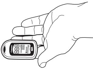
Il display del pulsossimetro **GO<sub>2</sub>** dispone di retroilluminazione integrata che si accende automaticamente in condizioni di luce insufficiente. Questo rende il display visibile anche al buio.
