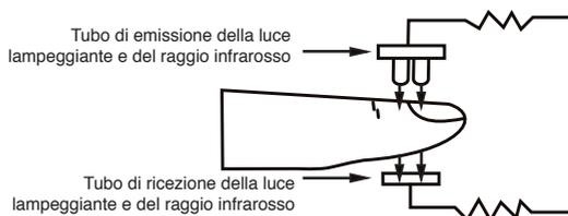
Figura 1 Principio di funzionamento
