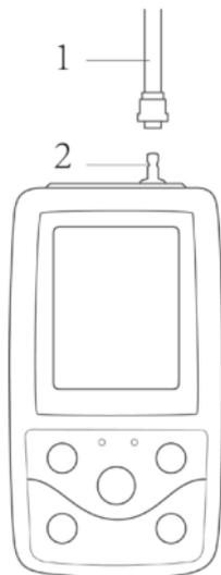
Figura 1.4.1 Attacco del tubo dell'aria esterno
