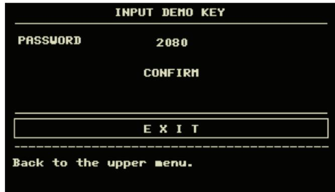
Figura 3-26 Inserimento della password per la modalità DEMO
