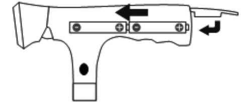
Posizionare due batterie AAA all'interno del manico, poi abbassare il coperchio per chiudere.
