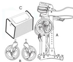
**D.** Procedere alla regolazione in altezza delle maniglie. Premere il perno di bloccaggio e regolare la posizione del manubrio all'altezza desiderata. Posizionare la borsa.
